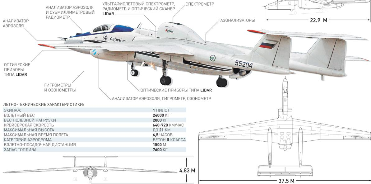
Table with technical characteristics: 1 ПИЛОТ, ВЗЛЕТНЫЙ ВЕС 24000 КГ, ВЕС ПОЛЕЗНОЙ НАГРУЗКИ 2000 КГ, КРЕЙСЕРСКАЯ СКОРОСТЬ 640-720 КМ/ЧАС, etc.
